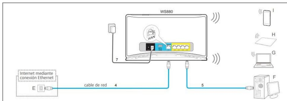
4. De esta manera el router WS880 contara con servicio de internet vía Ethernet y por ambas bandas (2.4 MHz y 5 MHz).
